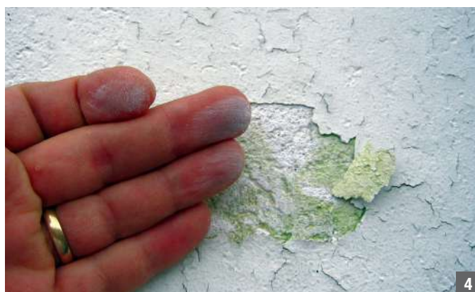
Ispitivanje prašnjavosti i "cvjetanja" površine
